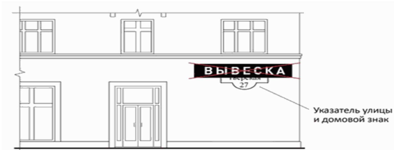
**Рисунок 18.** Размещение консольных информационных конструкций на расстоянии менее 10 м друг от друга.
