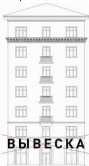
**Рисунок 12.** Нарушение требований к местам размещения информационных конструкций.
