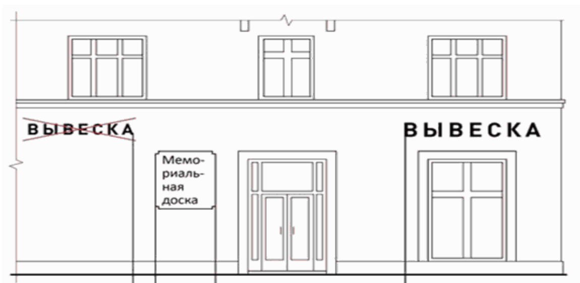
Рисунок 17. Перекрытие указателей наименований улиц и номеров домов.
